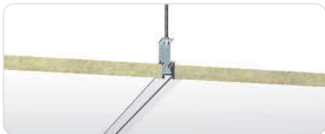
Pose tramée de plafond laine minérale
