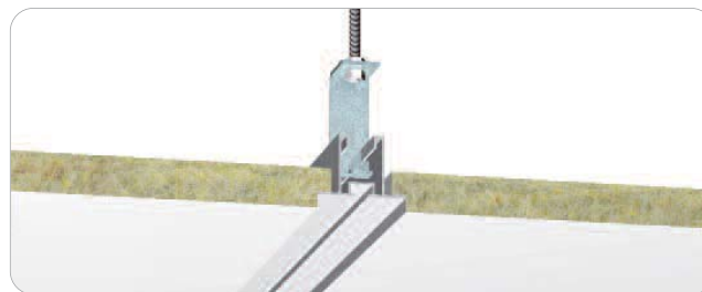
Pose tramée de plafond laine minérale décaissée
