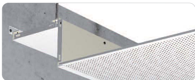
Plage avec jouée intégrée pour incorporation de store, d'éclairage ou de bouche de soufflage.
